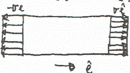
L'equazione della statica è  $\frac{d\sigma}{dx} = 0$  in  $\mathcal{C}$ , (9) 7
